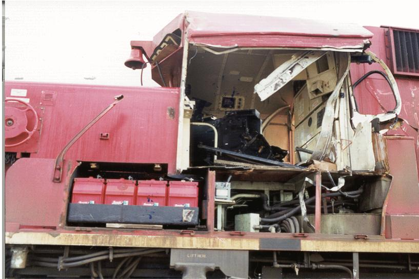
La cabine de commande de la troisième locomotive du train 472, CP 5757, a été enfoncée au niveau du pare-brise et de la porte du côté du chef de train par de grosses esquilles de contreplaqué qui se sont détachées des conteneurs quand ceux-ci se sont brisés au contact avec la troisième locomotive (voir la figure 3).
