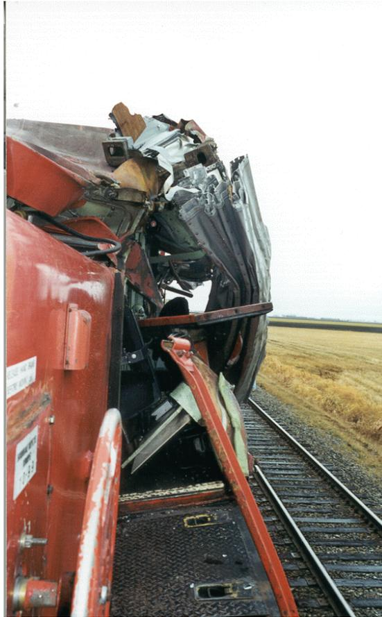
La deuxième locomotive du train 472, CP 5877, a aussi été éventrée du côté du chef de train et la paroi métallique a été retroussée vers l'arrière, exposant les batteries et l'intérieur de la cabine de la locomotive (voir la figure 2). Le fauteuil du chef de train a été arraché de ses fixations et on l'a retrouvé à environ 400 pieds de la locomotive, reposant sur le ballast entre les deux voies principales.
