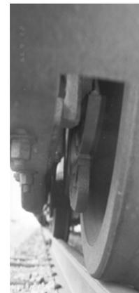
Figure 16 - Vues de côté du boîtier des roulements à rouleaux de locomotive (Nota : plaque de fixation sous le roulement)
