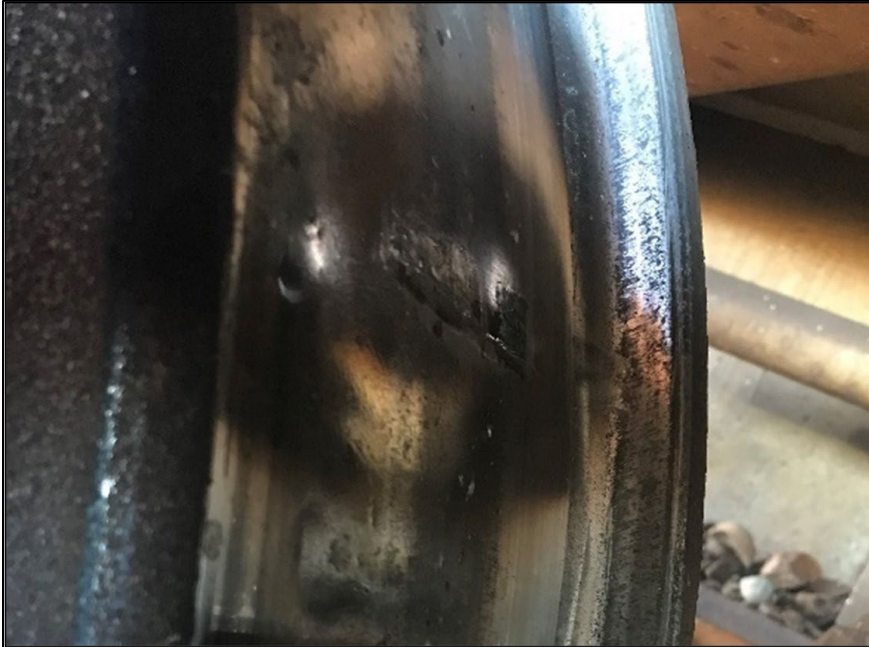
Figure 5. Dommages attribuables aux chocs à la table de roulement de la roue R1 du wagon CITX 151689 (Source : CP)
