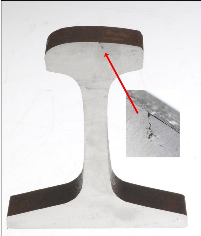
Figure 9. Coupe transversale du rail 1 montrant la fissure (Source : BST)
