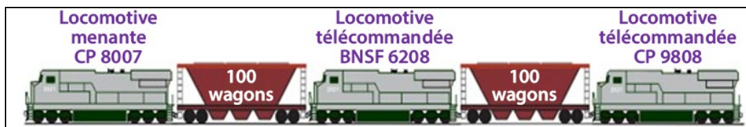
Figure 1. Illustration du train à traction répartie de l'événement à l'étude (Source : BST)
