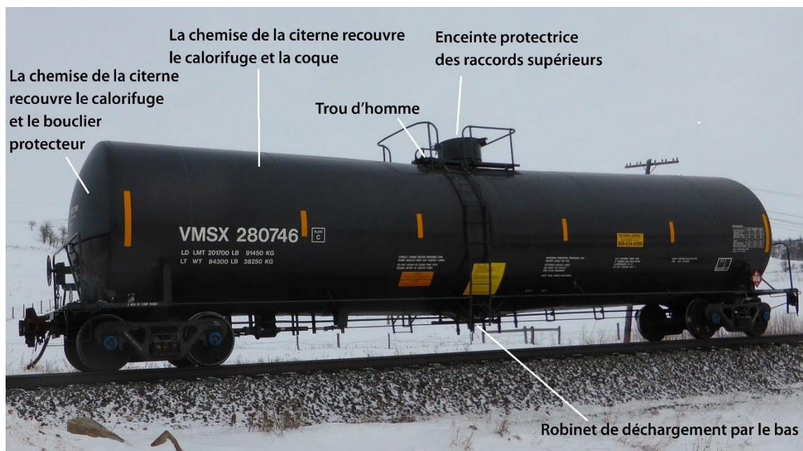
Figure 16. Aménagement général du wagon-citerne de catégorie 117R VMSX 280746 (5 e position derrière la tête du train) remis sur les rails. Une chemise et un calorifuge recouvrent la coque et le bouclier protecteur complet du wagon-citerne. Les dispositifs de décharge de pression sont situés à l'intérieur des enceintes protectrices des raccords supérieurs. (Source : BST)
