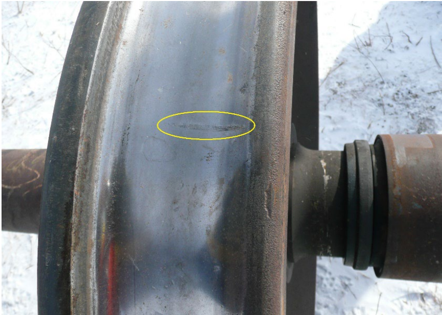
Figure 2. Marque d'impact sur la table de roulement R4 du wagon VMSX 280746 (Source : BST)
