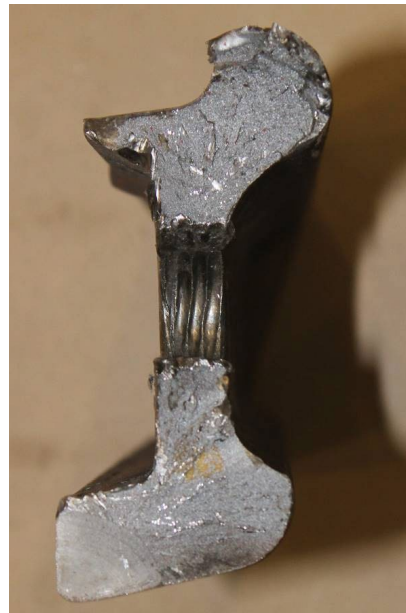
Figure 15. Empreintes des filets du boulon creusées dans un trou de boulon sur une éclisse mixte intérieure 132/136 RE de l'about du rail B
