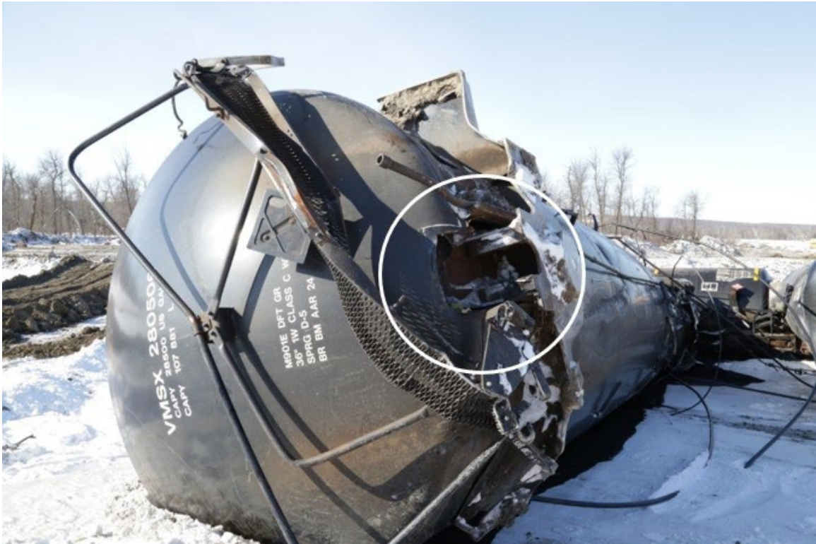
Figure 18. Séparation de la longrine tronquée du wagon-citerne VMSX 280506 (Source : BST)
