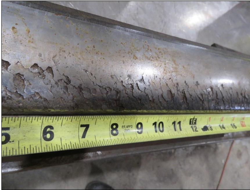
Figure 6. Condition de la table de roulement du champignon du rail récupéré sur le site de l'événement (Source : Chemin de fer Canadien Pacifique)
