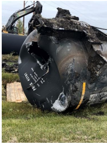
Figure 4. Dommages au wagon PROX 43787 (Source : Chemin de fer Canadien Pacifique)
