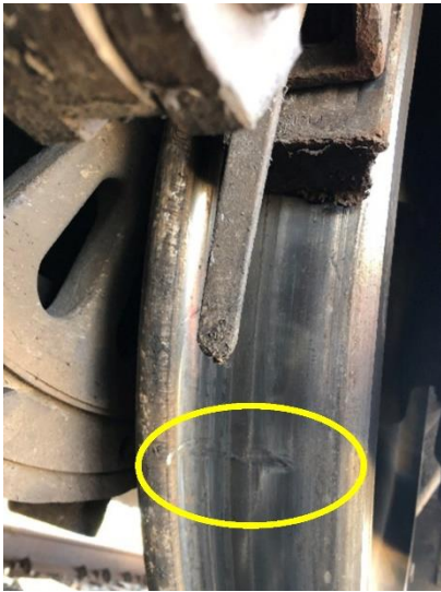
Figure 3. Éraflures sur la table de roulement de la roue L5 de la locomotive de tête (Source : BST)
