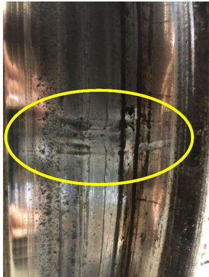
Figure 4. Éraflures sur la table de roulement de la roue L6 de la locomotive de tête (Source : BST)
