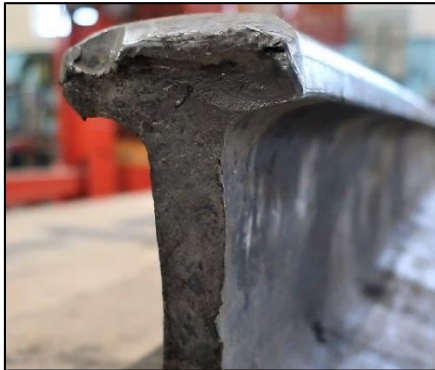
Figure 6. Coupe transversale du rail (Source : Chemin de fer Canadien Pacifique)
