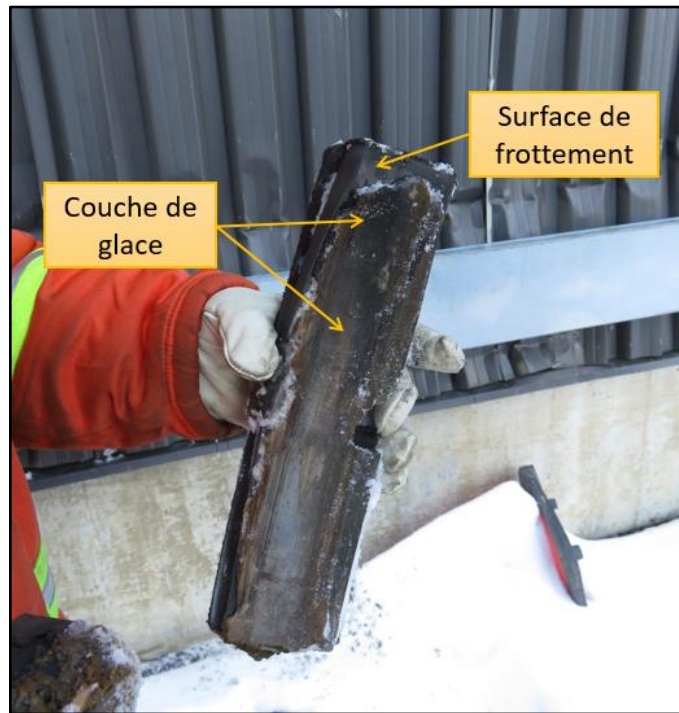
Figure 7. Couche de glace sur une semelle de frein du wagon HS 3205 (Source : BST)
