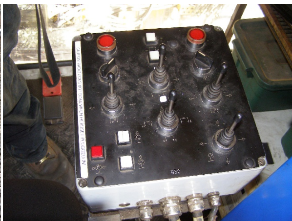
Figure 8. Commutateurs rotatifs et manches dans la cabine de la bourreuse (source : BST)
