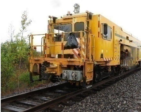
Figure 5. Bourreuse Unimat avec son extrémité allongée vers l'avant (source : BST)
