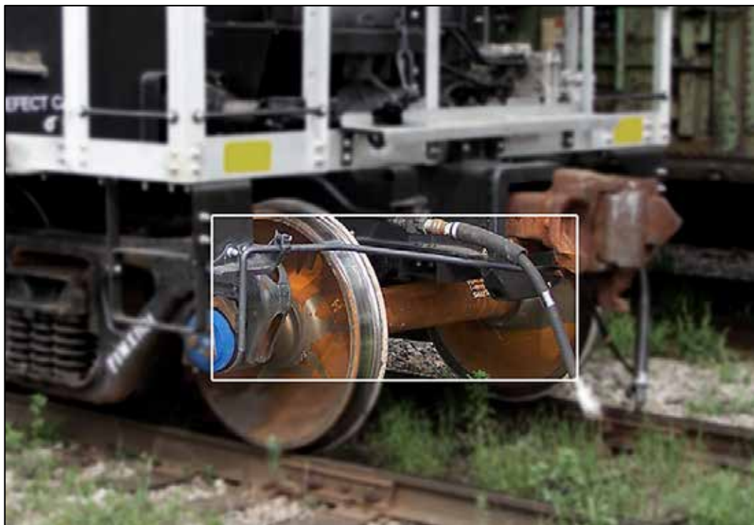
Figure 4. Levier de dételage sur un wagon semblable (Source : Ian A. McCord)
