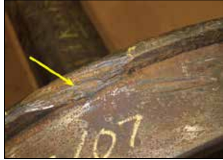
Photo 12. Vue des dommages mécaniques sur la roue du wagon DWC 627099
