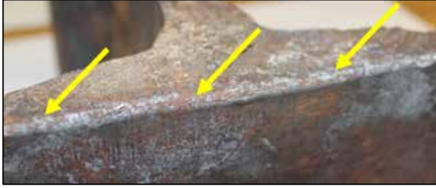
Photo 11. Bord arrondi au niveau du patin du morceau de rail numéro 9 (flèches)
