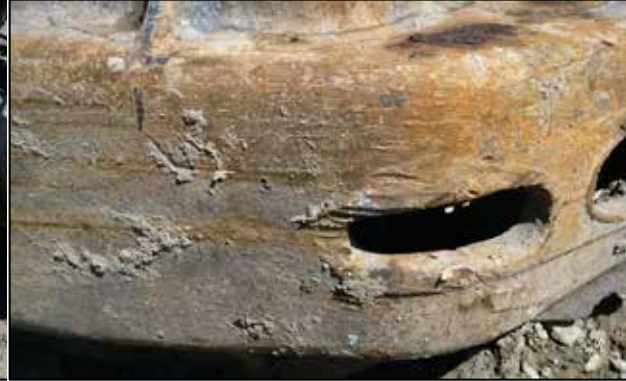
Photo 7. Gros plan du dessous du longeron de bogie du 62 e wagon
