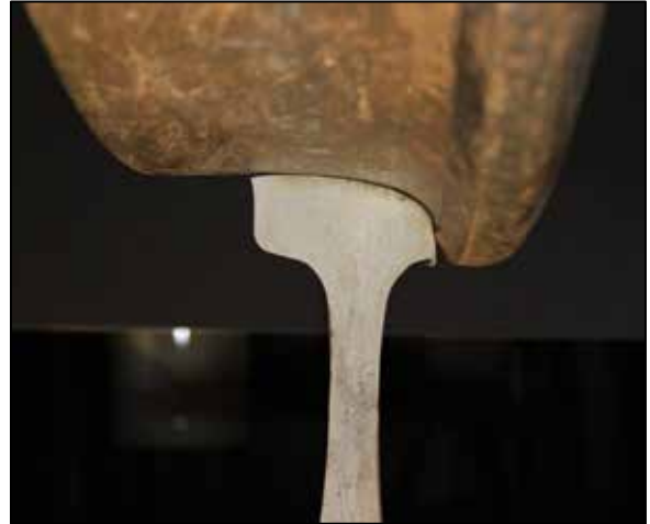
Photo 8. Profil réel de la roue L-1 du 62e wagon comparé au contour du rail haut (sud). Remarque : La surface de contact roue-rail s'est déplacée vers le côté extérieur du rail.
