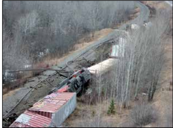
Photo 2. Vue vers l'avant du train montrant le matériel roulant déraillé du côté nord de la voie (Source : Service d'incendie d'Edmundston)
