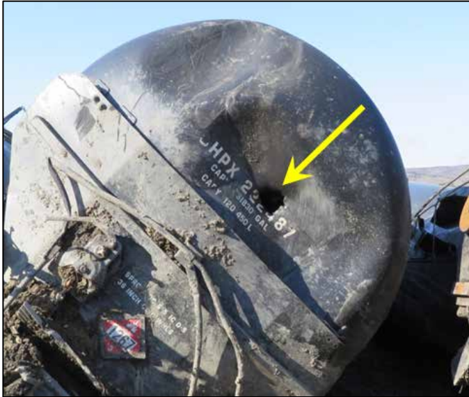
Photo 9. Perforation dans la partie supérieure non protégée de la tête
