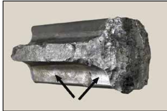
Photo 8. Marques de brunissage sur le patin de la lame d'aiguille nord
