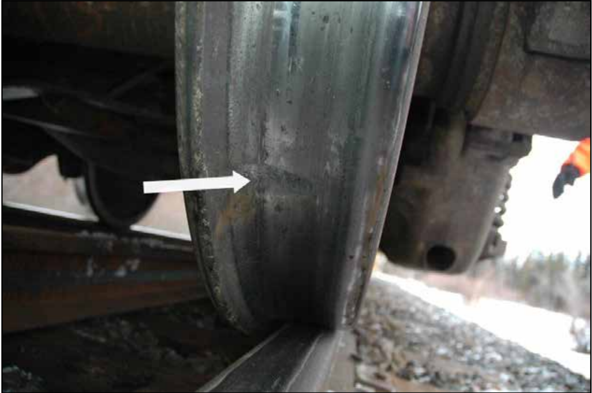
Photo 4. Marque d'impact sur la table de roulement d'une roue du wagon 38
