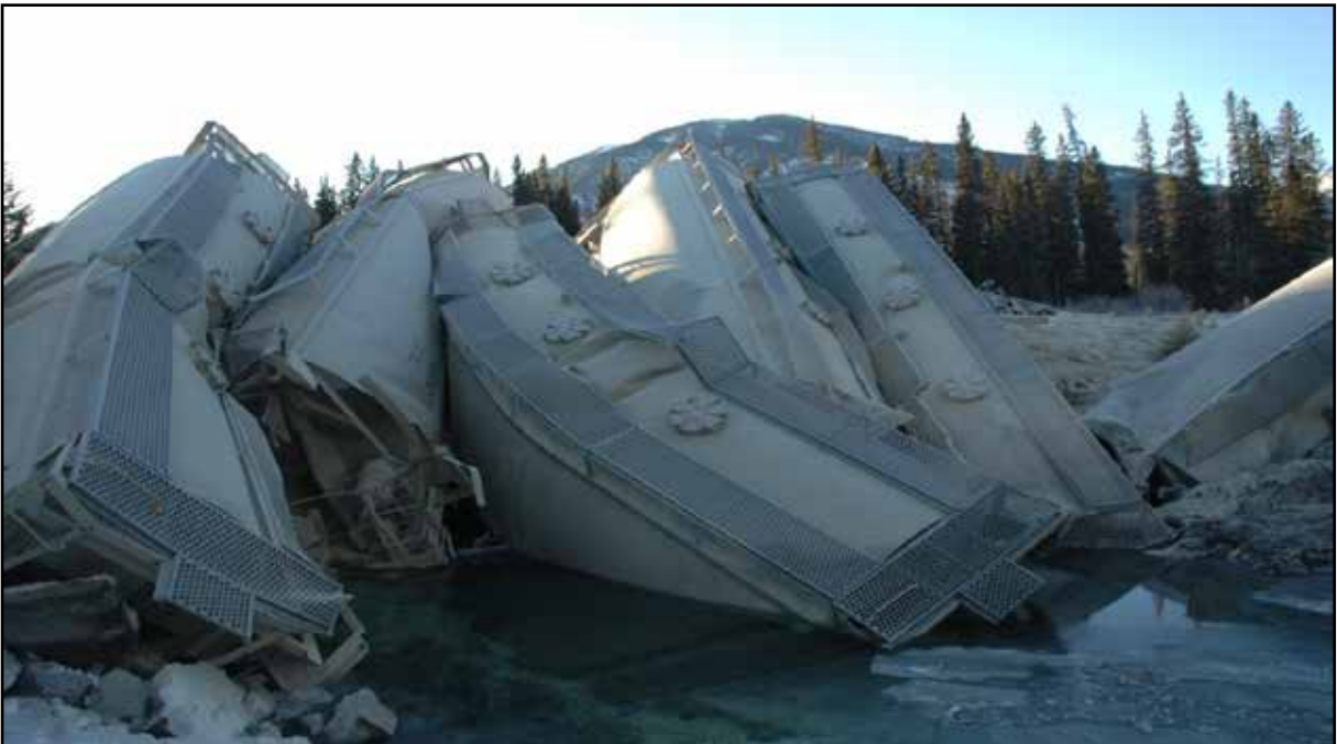
Photo 3. Empilement de wagons déraillés sur le pont
