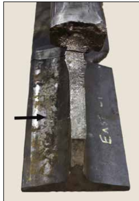
Photo 8. Marques de brunissage sur le patin de la lame d'aiguille nord
