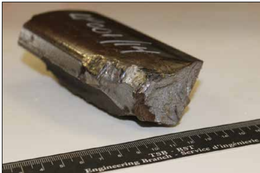
Photo 6. Morceau du rail haut montrant des marques d'écrasement et d'impact de roue
