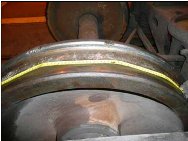
Photo 3. Marques d'impact sur le boudin et la table de roulement de la roue L-4
