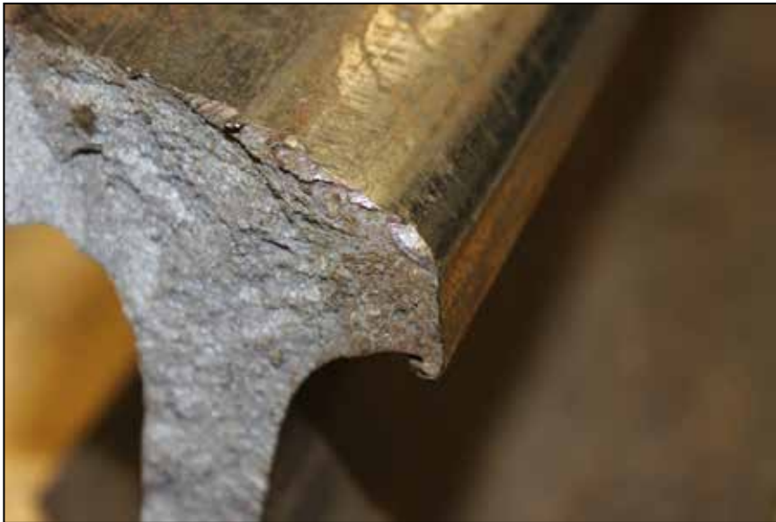
Photo 6. Morceau du rail haut montrant des marques d'écrasement et d'impact de roue
