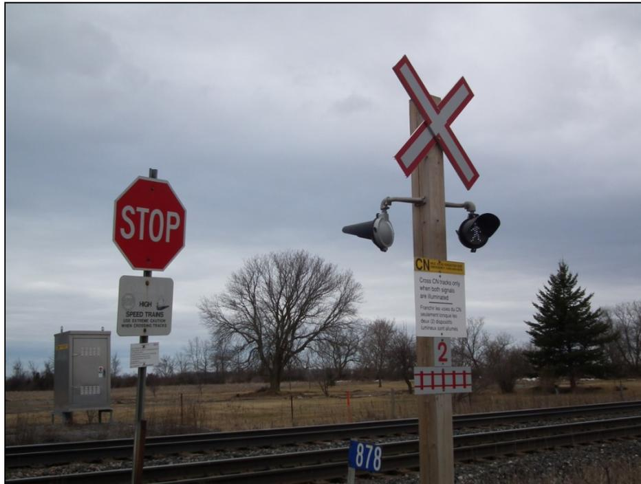
**Photo 5.** Système d'avertissement de passage à niveau avec feux de signalisation piétonniers (subdivision de Kingston)
