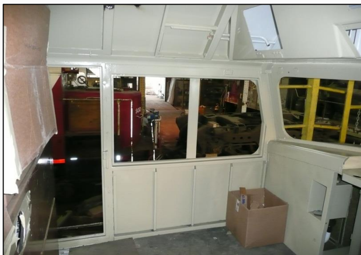
Photo 9. Charpente à découvert de l'intérieur de la cabine côté du chef de train (source : BST)
