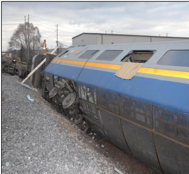
Photo 3. Fenêtre d'issue de secours utilisée sur la voiture VIA 3454 (source : police régionale d'Halton)
