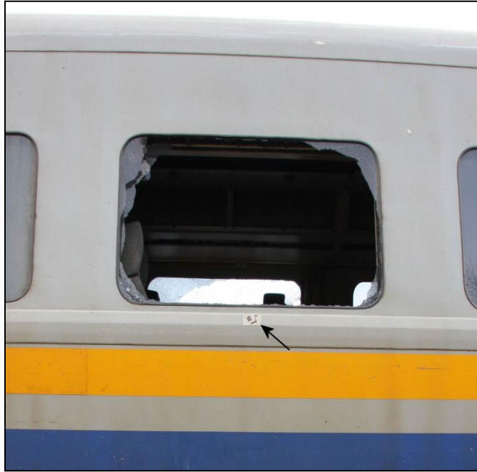
Photo 11. Marquage extérieur sur une fenêtre de sortie de secours (source : TSB)
