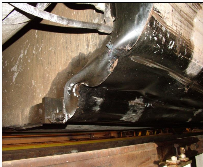
Photo 5. Réservoir de carburant bosselé de la locomotive VIA 6444 (source : BST)
