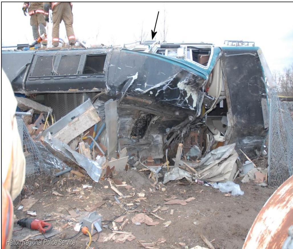
Photo 1. Locomotive VIA 6444 sur le côté et toit effondré de la cabine. Porte du côté du mécanicien responsable sur le dessus (source : police régionale d'Halton).
