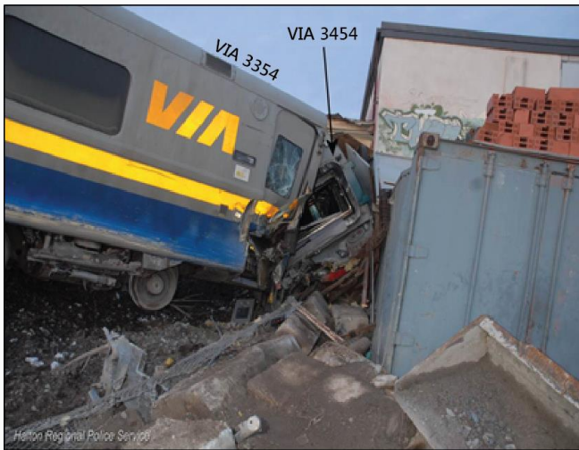
Photo 4. La porte arrière de la 1 re voiture a été découpée pour créer une ouverture tandis que les 2 portes latérales de la 2 e voiture (VIA 3354) étaient bloquées (source : police régionale d'Halton)
