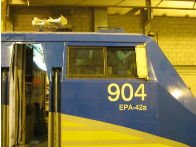
Photo 4. Locomotive VIA 904 équipée en rattrapage d'un klaxon près de la tête de la locomotive
