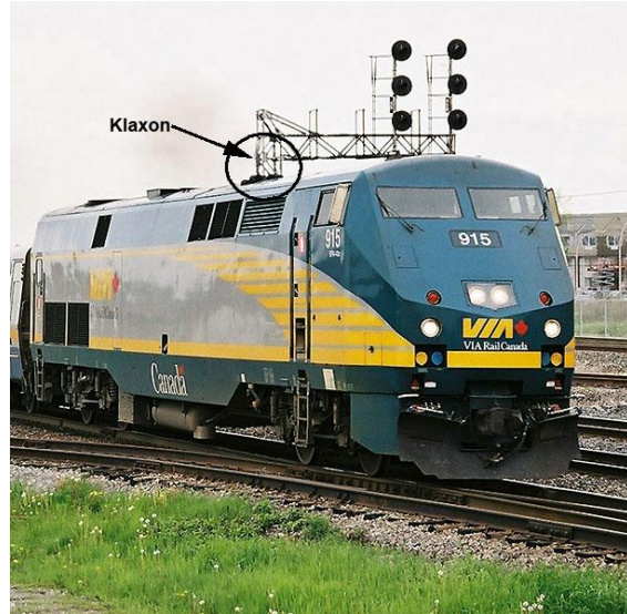
Photo 5. Locomotive de VIA 71 équipée d'un klaxon au milieu du toit
