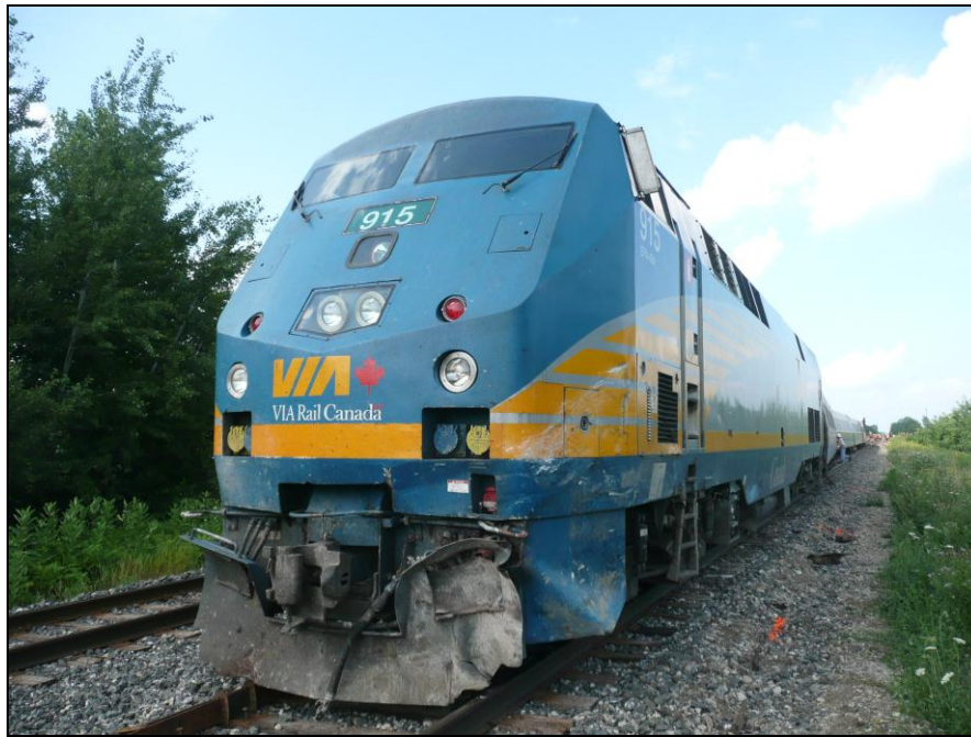
Photo1. La locomotive VIA 71 et son chasse-pierres endommagé
