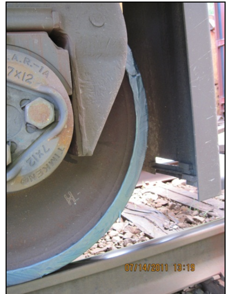
Photo 1b. Cette photo rapprochée de la roue L3 du wagon DTTX 724638 montre un bleuissage et de l'abrasion sur la face de la jante
