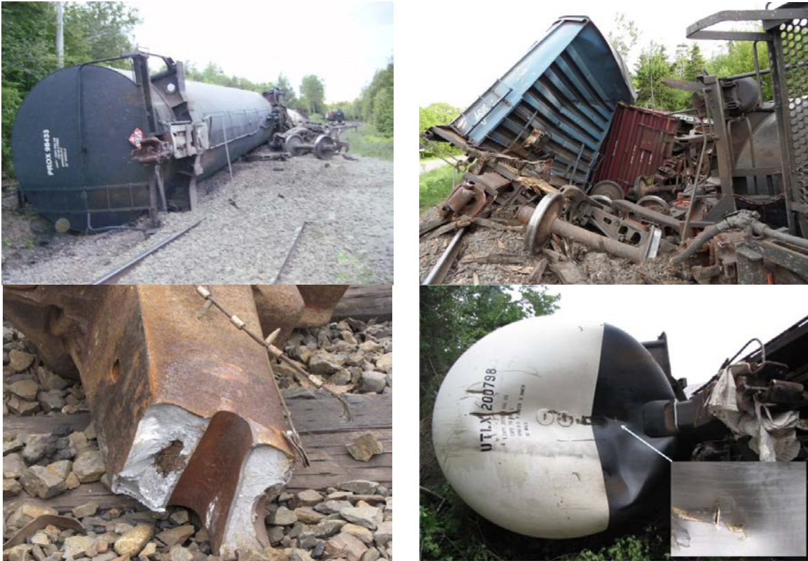
Photo 1. Des wagons qui ont déraillé. Dans la photo inférieure droite, la flèche indique l'emplacement de la perforation de la tête de citerne du wagon de résidus de peroxyde d'hydrogène.
