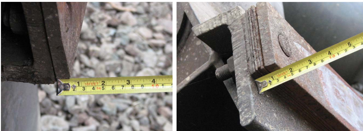
Photo 2. Glisseurs de caisse à l'extrémité B du wagon PROX 98433 (photo de gauche - pas de cales à l'emplacement BD; photo de droite - cales d'environ \frac{7}{8} po d'épaisseur à l'emplacement BG).
