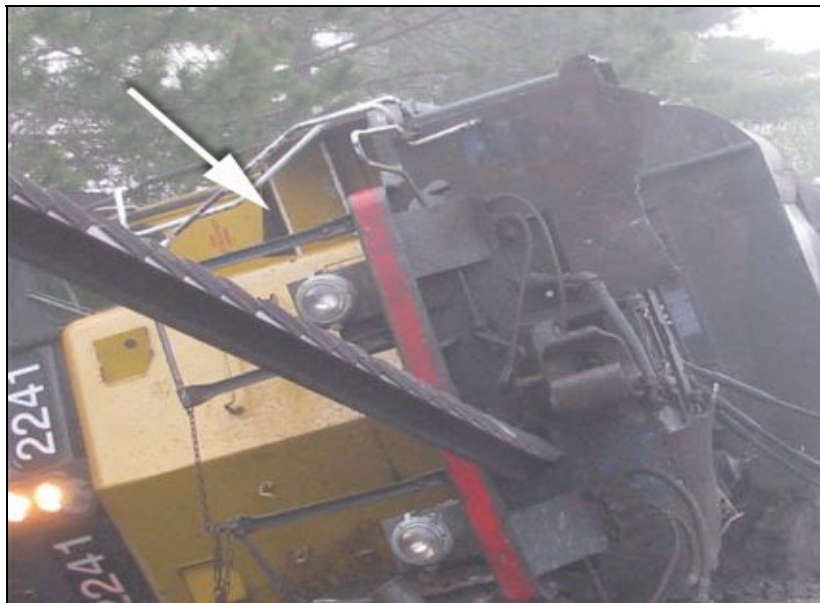
Photo 3. Couvercle du logement des batteries, qui bloque la porte de la cabine
