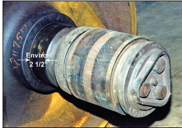
Photo 3. Déplacement d'une roue sur la portée de calage (2 ½ pouces), exemple typique d'une roue lâche
