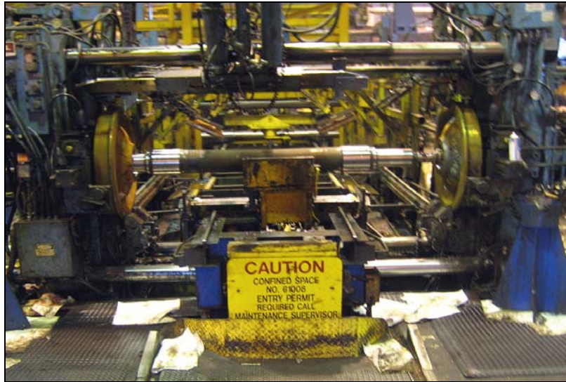
Photo 2. Presse pour le montage des roues sur les essieux
