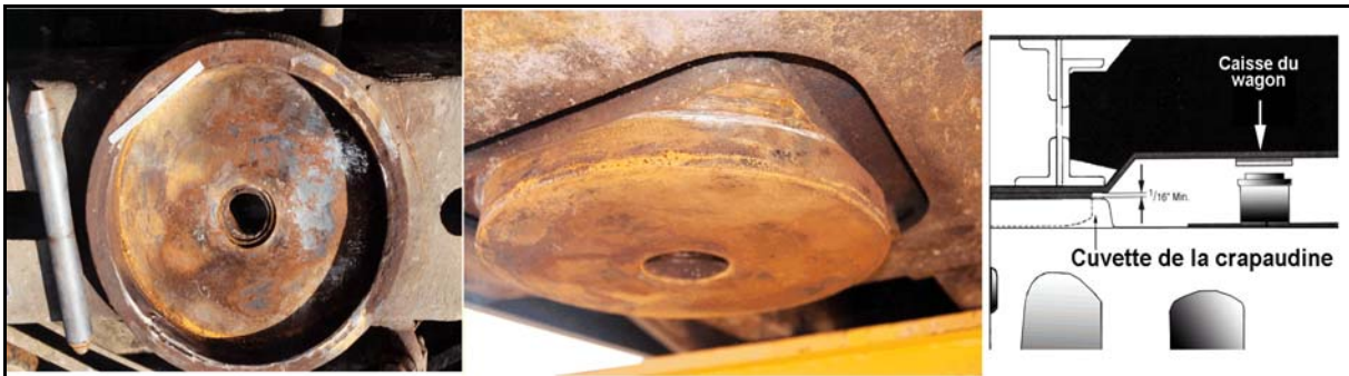
Photo 2. Le bord de la traverse danseuse du wagon FURX 818699 était usé à quatre endroits. L'usure aux angles de la crapaudine correspondait à celle du bord de la traverse danseuse. Le croquis indique les espaces de dégagement entre les deux pièces.
