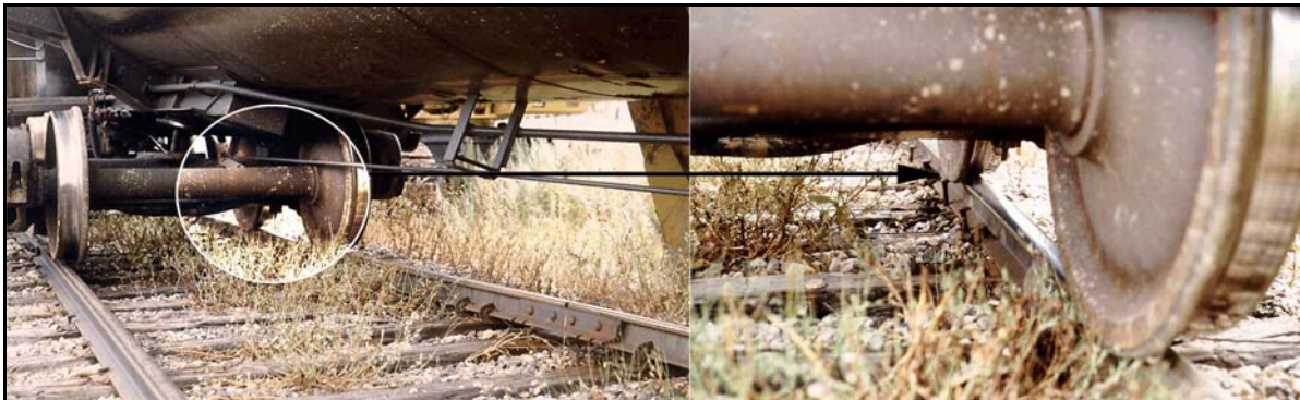
Photo 1. Le bout B du wagon GATX 48058 est resté sur le rail sud incliné. Un gros plan de la zone ombrée montre l'arrachement des crampons qu'on a observé sous le bogie du bout B.
