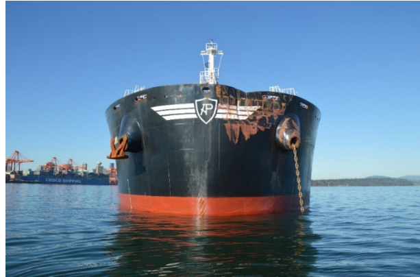
Figure 5. Dommages subis par le Caravos Harmony (Source : BST)
