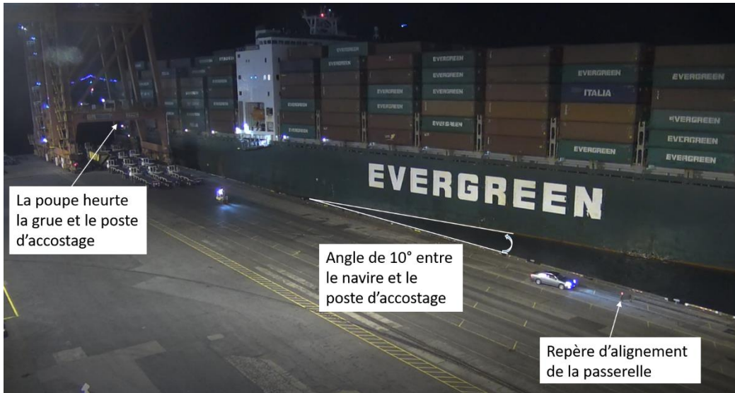
Figure 5. Image tirée de la séquence de la télévision en circuit fermé présentant l'Ever Summit au moment de l'impact (Source : GCT Canada, avec annotations du BST)
