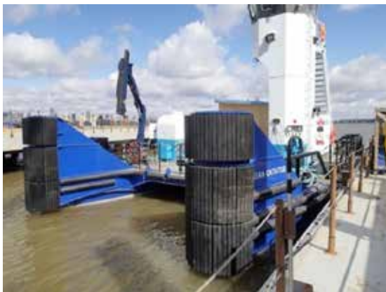
Figure 4. Les deux coques du remorqueur Ocean Catatug 1 (Source : Groupe Océan)
