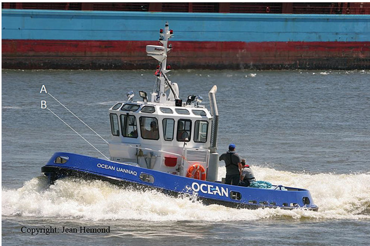
Figure 13. Photo de l' Ocean Uannaq montrant l'emplacement de l'armoire de rangement et de la rambarde (A) ainsi que du radeau de sauvetage (B) (Source : Jean Hemond, avec annotations du BST)
