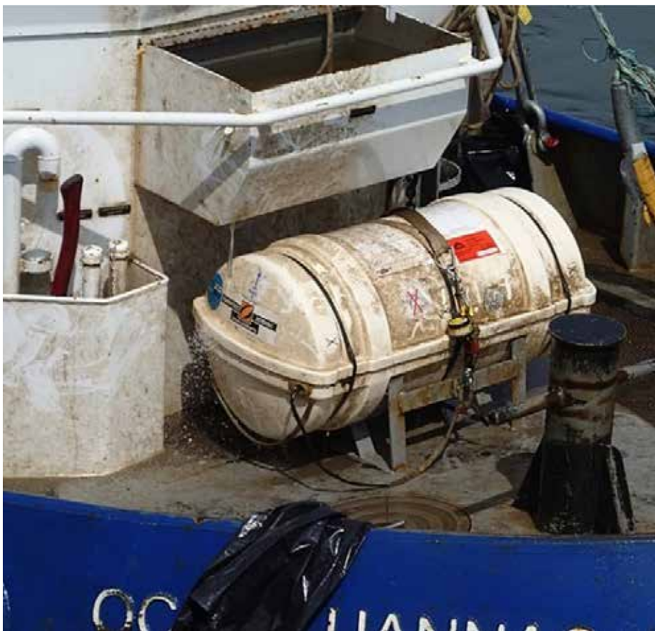
Figure 14. Photo prise après l'événement qui montre la position du radeau de sauvetage non libéré et du largueur hydrostatique apparemment intact
