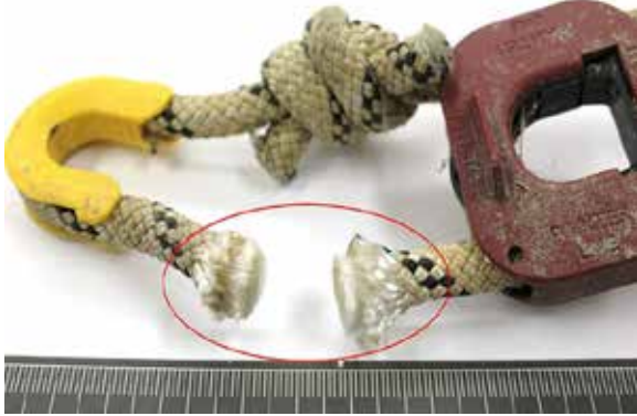
Figure 16. Photo montrant la coupe nette de la ligne du largueur hydrostatique du radeau de sauvetage
