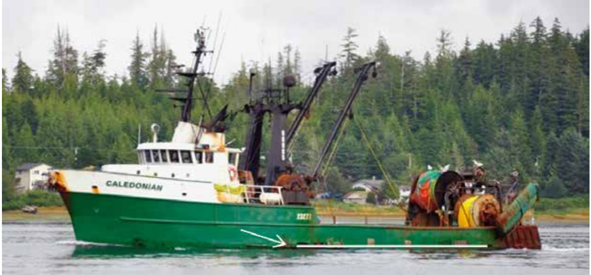
Photo 4. Caledonian chargé. La ligne blanche sur la coque indique le niveau estimé du pont de pêche du navire. (Source : Eric Sorenson, avec annotations du BST)
