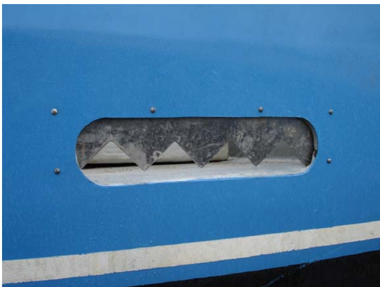
Photo 5. Sabord de décharge avec plaque en dents de scie, vu de l'extérieur du bateau
