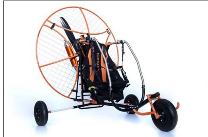
Figure 3. Un RS Ultra Kangook MF représentatif avec un train tricycle d'un fabricant tiers. La voilure ne figure pas sur cette image. (Source : Paramoteurs Kangook)
