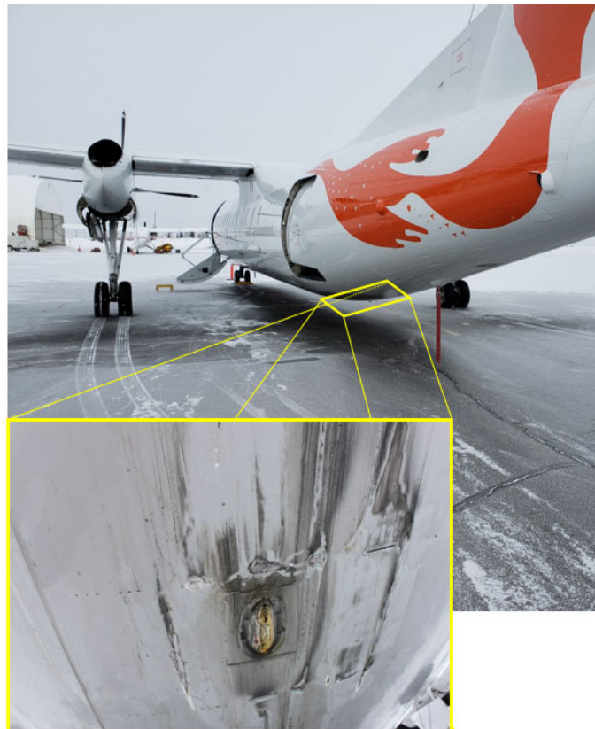
Figure 2. Vue arrière d'un autre DH8C et aperçu des dommages de C-GXAI (Source: BST)
