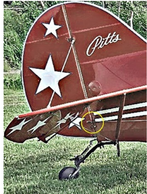
Figure 4. Queue de l'avion montrant la position du guignol (cercle jaune) (Source : Frédéric Bilodeau, avec annotations du BST)
