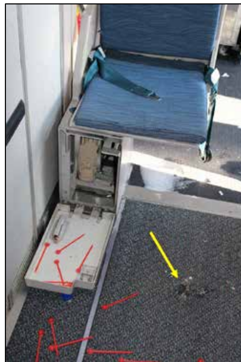
Figure 12. Plancher endommagé au-dessus du cadre FR65
