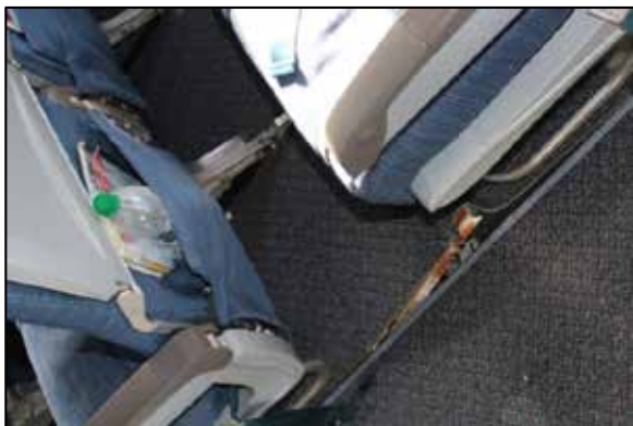
Figure 10. Plancher endommagé devant le siège passager 31D
