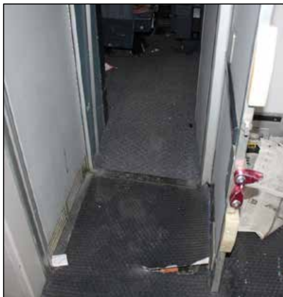
Figure 9. Plancher endommagé derrière la porte du poste de pilotage
