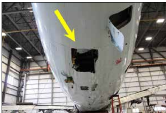
Figure 8. Fuselage endommagé montrant un grand trou
