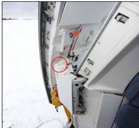
Figure 5. Bouton-poussoir de désarmement du verrou de gouverne de la porte L1 (encerclé)
