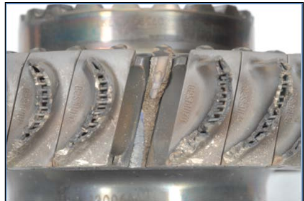
Photo 5 Défaillance de la roue du premier étage de turbine
