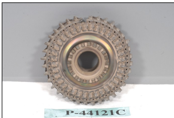
Photo 4. Roue du premier étage de turbine
