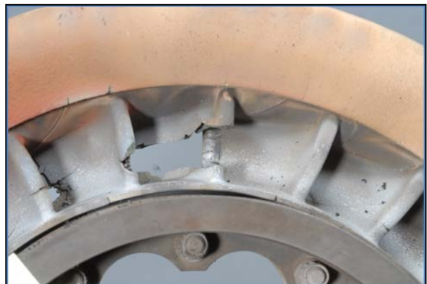
Photo 8. Perçage par brûlure d'une aube de stator
