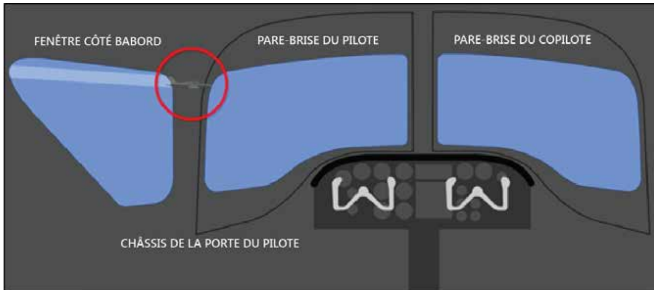
Figure 6. Vue depuis le poste de pilotage de l'aéronef C-GFCH montrant que la vision du pilote était partiellement obstruée par la structure de l'aéronef (Remarque : L'image n'est pas à l'échelle)
