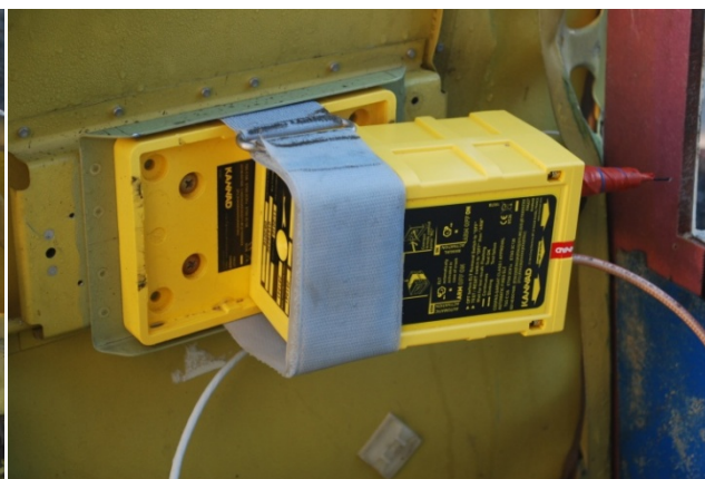
Photo 2. ELT glissant sous la sangle desserrée
