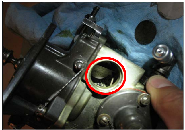
Photo 1. Débris du palier dans le régulateur de turbine de puissance
