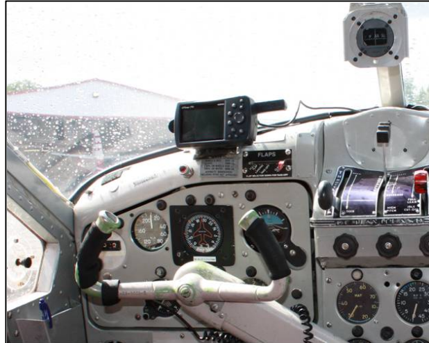
Photo 2. Installation similaire du GPS sur le tableau de bord
