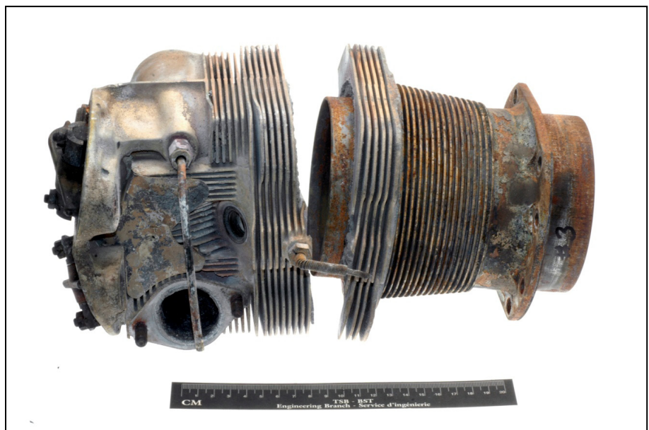
Figure 1. Le cylindre numéro 3 déposé du moteur
