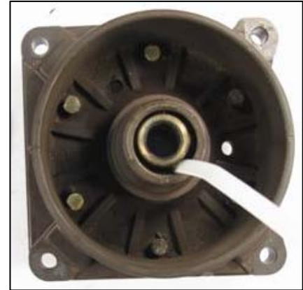
Photo 1. Bague du bloc du distributeur ayant du jeu retenue par une attache Tyrap
