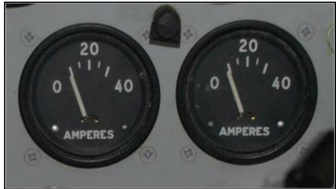
Photo 1. Indications de l'ampèremètre de l'aéronef immatriculé C-FBJA quand les alternateurs sont sur OFF.
