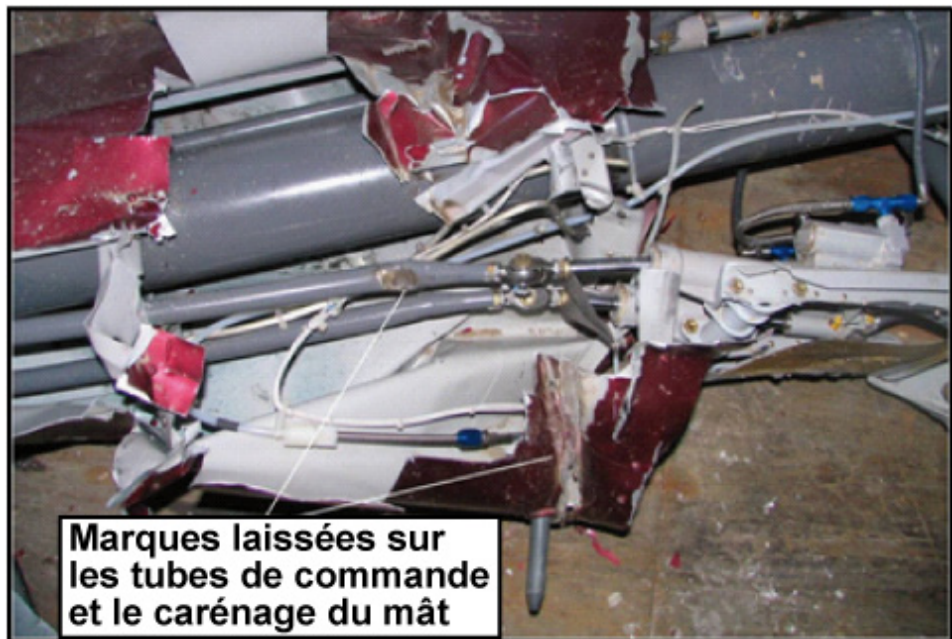
Photo 1. Marques laissées par le câble sur les tubes de commande.
