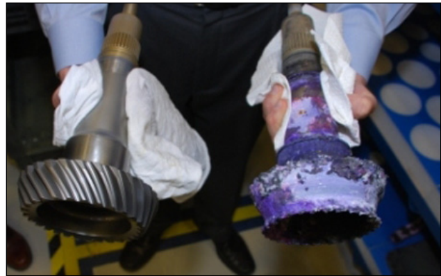
Photo 6. À droite, pignon d'entraînement du rotor de queue endommagé
