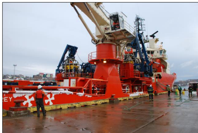
Photo 17. Grue du Atlantic Osprey (capacité de 50 tonnes)
