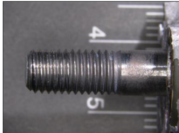
Photo 8. Goujon supérieur resté en place sur le carter de la BTP de CHI91
