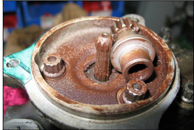
Photo 4. Cannelures d'entraînement du moteur gauche et accouplement
