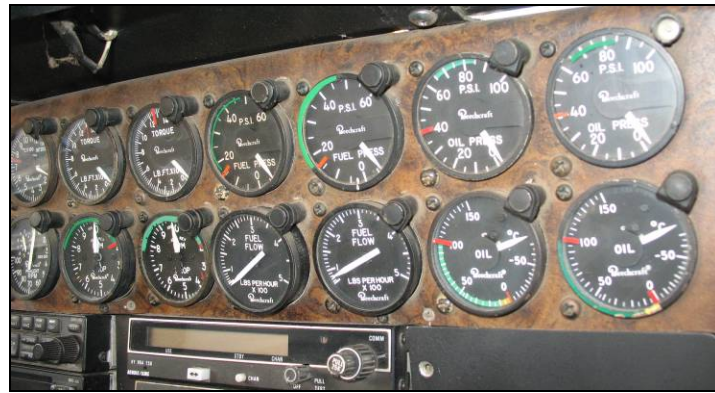
Photo 3. Disposition horizontale des instruments moteurs
