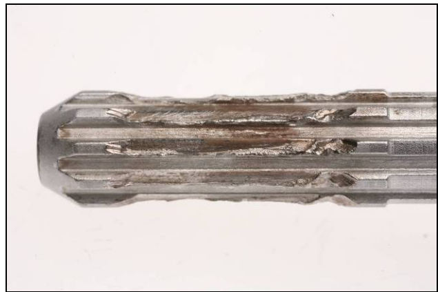
Photo 5. Gros plan de l'usure externe des cannelures
