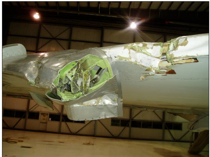
Photo 2. Dommages à l'avion – bord d'attaque de l'aile droite.
