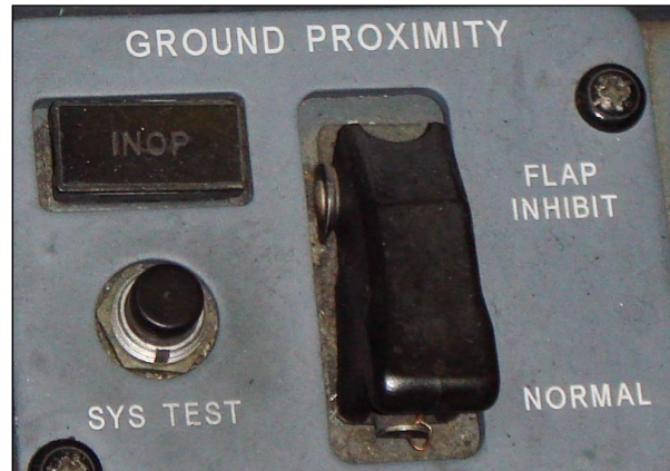
Photo 1. Panneau de commande de l'EGPWS.
