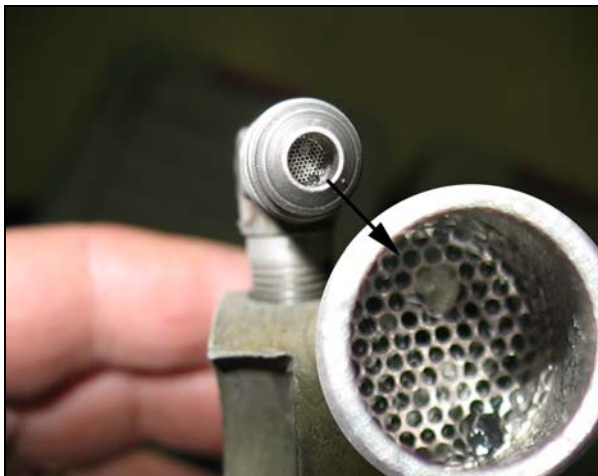
Photo 3. Gouttelettes d'eau surfondue et formation de glace dans la crépine du dispositif de retour de carburant.
