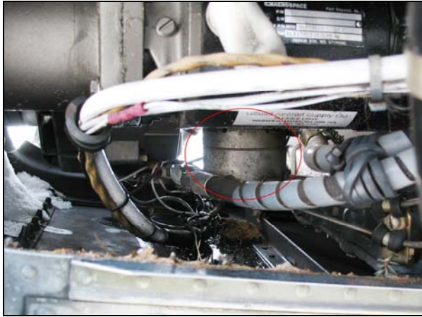
Photo 1. Emplacement du distributeur de carburant dans la partie inférieure avant du moteur.
