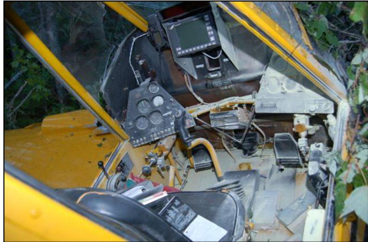
Photo 3. Intégrité du poste de pilotage.
