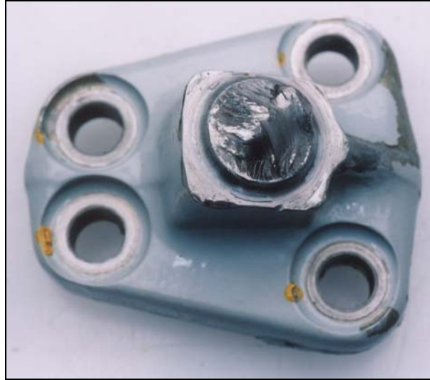
Photo 2. Axe brisé du support droit du pylône
