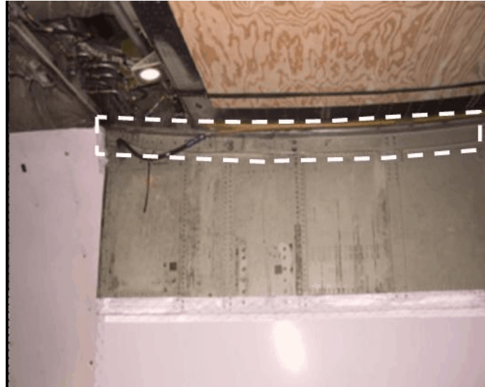
Photo 1. Les pointillés correspondent à la cornière de fixation de l'aile.
