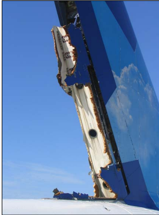
Photo 1. Vue de la dérive et des restes de la gouverne de direction - côté droit
