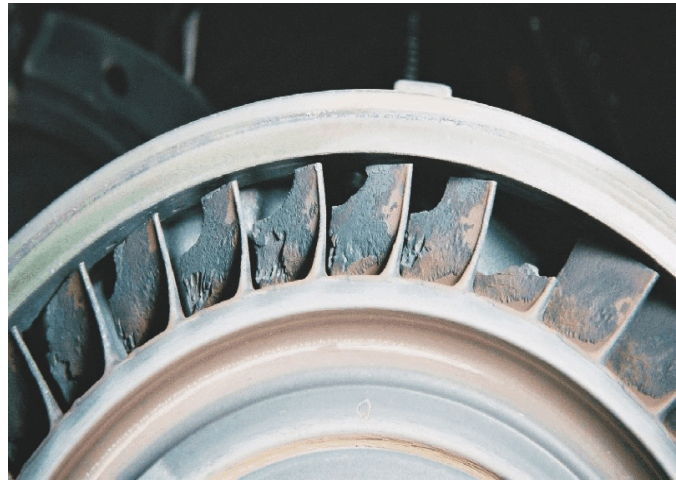
Photo 1. Sulfuration de la turbine du générateur de gaz numéro 1
