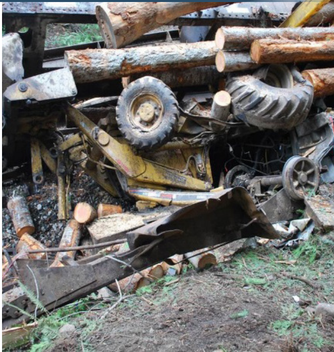
PHOTO 6. Pelle rétrocaveuse ensevelie sous des grumes au point de déraillement
