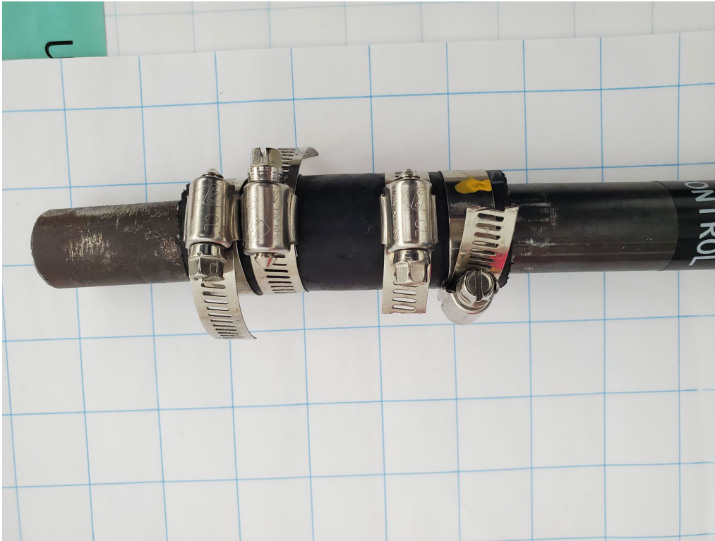
Figure 12. Reconstitution de la réparation temporaire finale (Source : BST)
