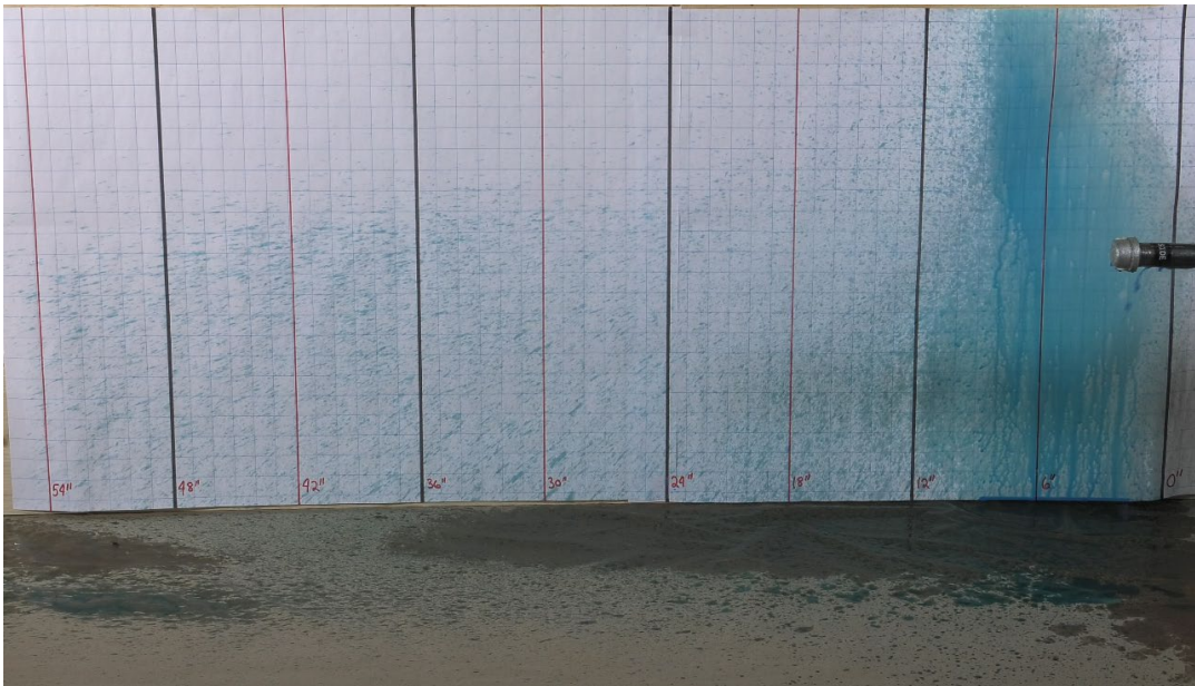
Figure B2. Résultats de l'essai de pulvérisation de carburant en 2 dimensions. Il convient de noter que la pulvérisation serait en 3 dimensions et qu'une pulvérisation à proximité d'une machine pourrait éclabousser ou s'égoutter sur les surfaces avoisinantes. (Source : BST)
