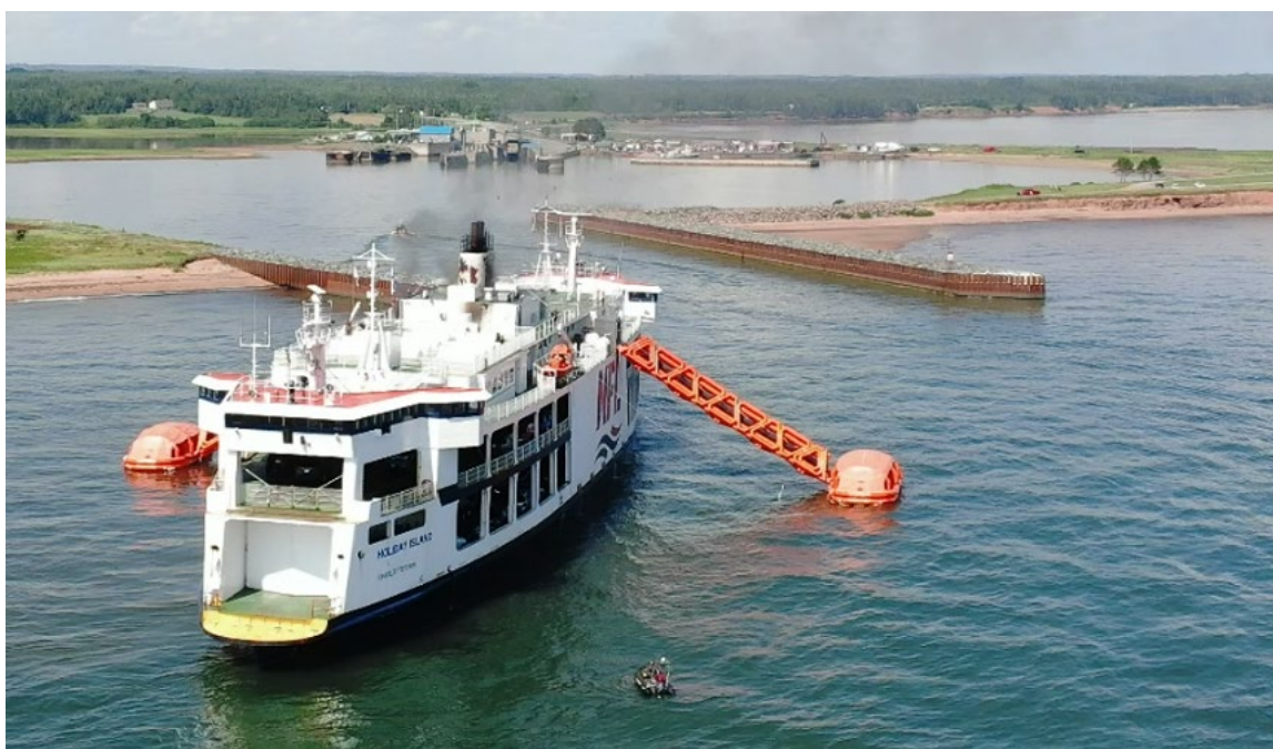
Figure 4. L' Holiday Island à l'entrée du terminal maritime de Wood Islands, les glissières d'évacuation en mer et les radeaux de sauvetage déployés (Source : Service d'incendie de North River, île-du-Prince-Édouard)
