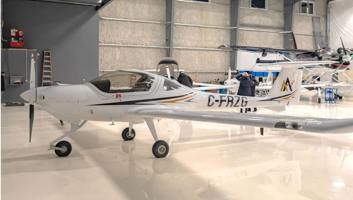
Le fuselage de type semi-monocoque est construit principalement en plastique renforcé de fibres de verre, et les ailes sont en construction sandwich et de type semi-monocoque avec un longeron en I doté de capuchons en plastique renforcé de fibres de carbone.
